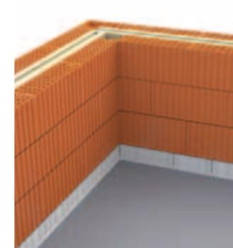
Les panneaux isolants sont insérés à l'avancement du montage des deux parois jusqu'à la hauteur finale du mur. Suivant le sens de pose (100 cm ou 120 cm), les premiers panneaux sont posés à la fin du 4<sup>ème</sup> ou du 5<sup>ème</sup> rang.
